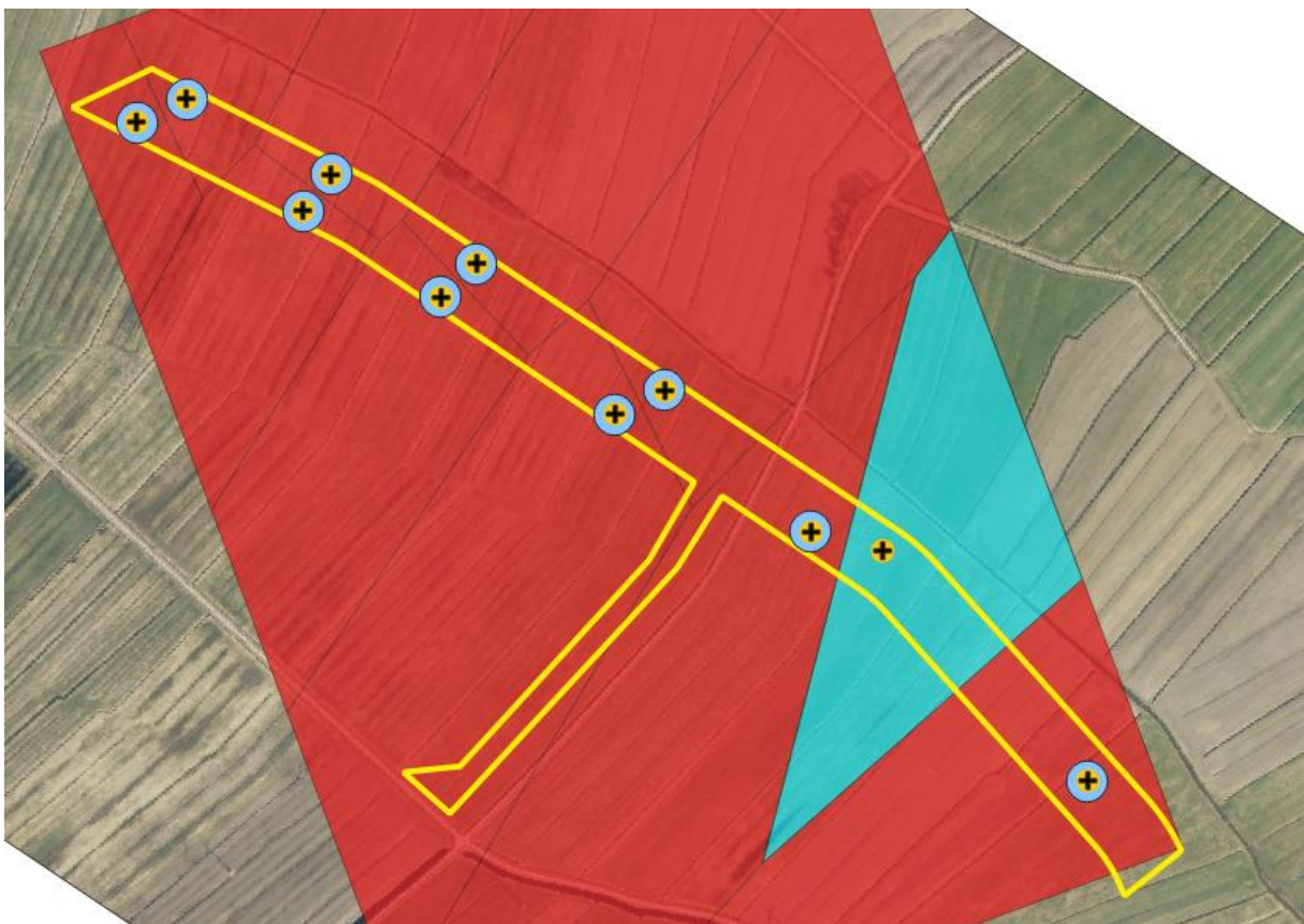
Abbildung 4: Darstellung der Voronoi-Polygone zur Abschätzung der Verbreitung potenziell sulfatsaurer Bodens (rote Flächen) und Bodens ohne PSSB-Material (blaue Fläche)
